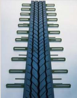
YS II型は近年の耐震設計橋梁に必要とされる、中伸縮・大遊間に対応可能な大型ゴムジョイントです。また、橋梁の免震・分散設計を考慮し、常時設計伸縮量最大200mm(±100mm)、最大床版遊間(最低温度時)600mmまで対応が可能です。
