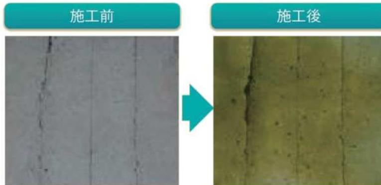
意図的にひび割れを発生させたコンクリート平板上の可視性を確認しました。
